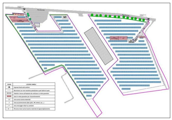
Figura 3-13 – Area di cantiere per la realizzazione del campo fotovoltaico
