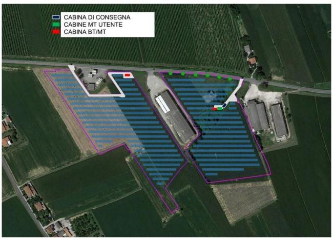
Figura 3-1 – Ubicazione delle cabine a servizio dell'impianto
